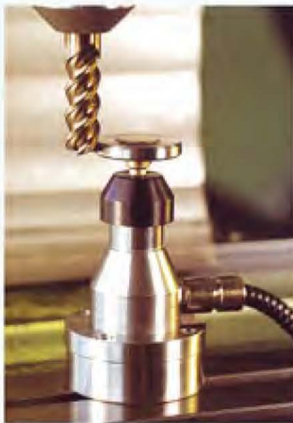
Auto. Tool Length & Radius Detector.
